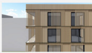
Fassadenmaschenbleche vertikale Holzoberfläche mit Schiebeläden
