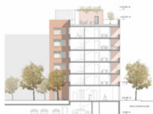
ANSICHT WEST | SCHNITT A-A M 1:200
