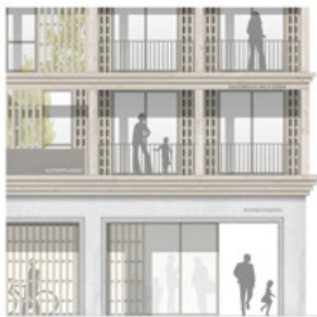
K6 EG AUS RECYLINGBETON OGS ALS HOLZBAU
