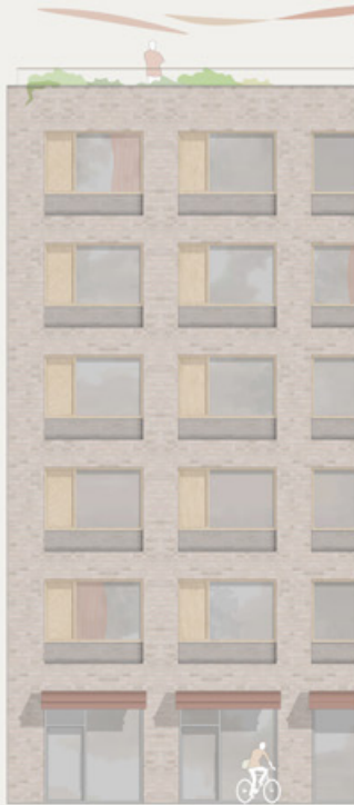
Fassade Detaildarstellung Materialität | 1:50 Außenwandstruktur wird plastisch durch vorgelagerte Zuganker sowie durch Rückbildung der Fenstereinfassungen, Verankerung der Fensterrahmen und Verankerung der Fensterrahmen im Rahmen-Bau durch Zuganker
