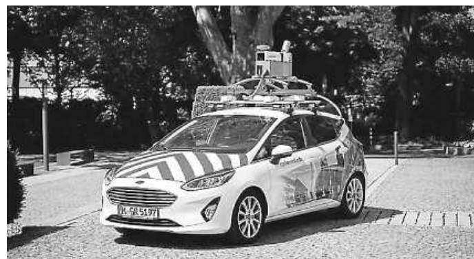
Vollausgestattetes Aufnahmefahrzeug mit spezieller Kamera und Laserscanner. Foto: Cyclomedia Deutschland GmbH
