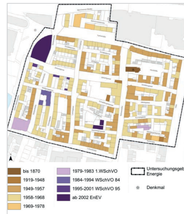
Baualtersklassen der Gebäude © Stadt Heilbronn; Kartengrundlage Stadt Heilbronn, ebök-Bearbeitung 2014.
