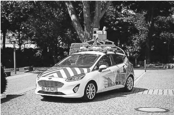
Voll ausgestattetes Aufnahmefahrzeug mit spezieller Kamera und Laserscanner Foto: Cyclomedia Deutschland GmbH
